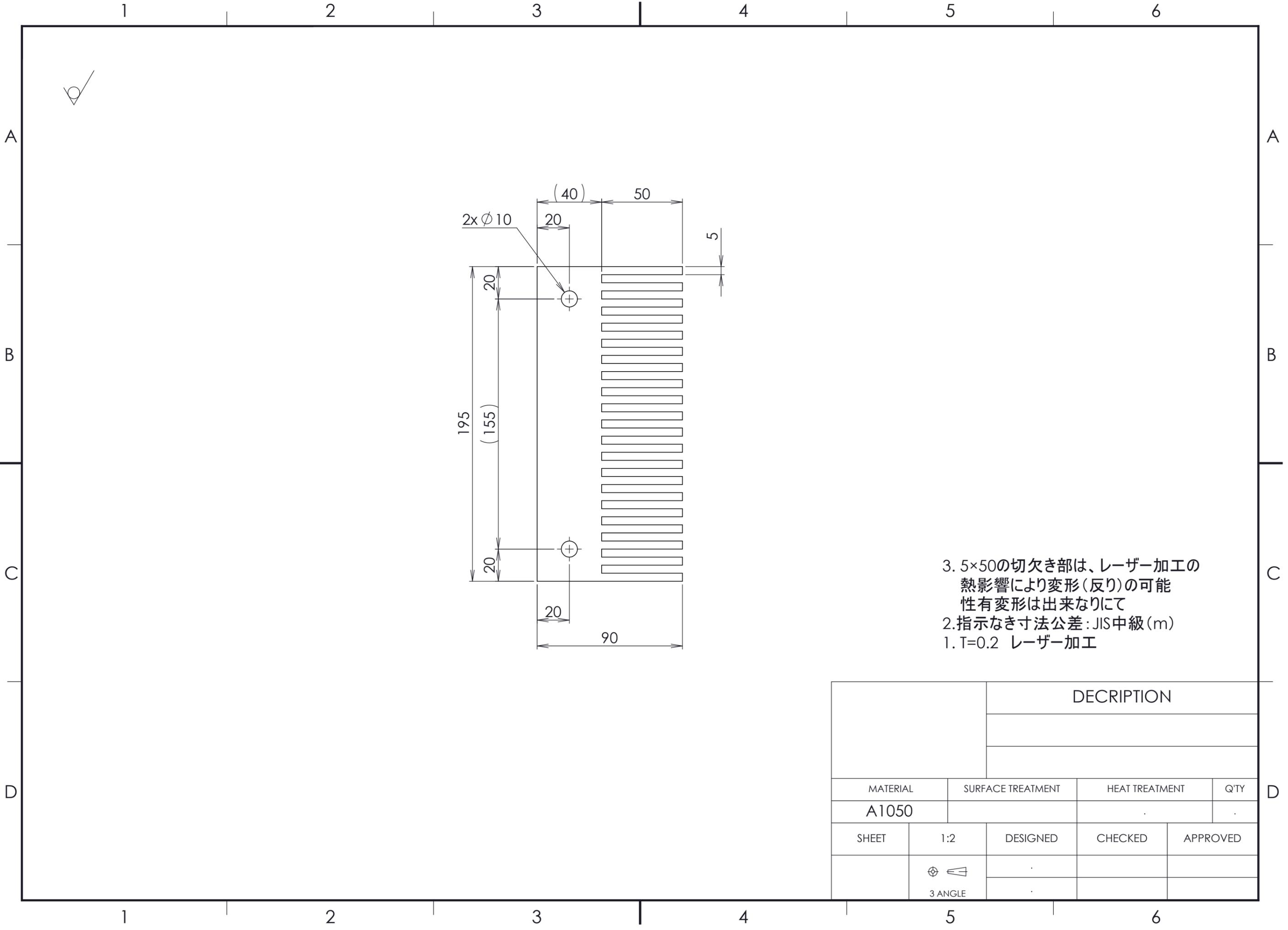
3. 5×50の切欠き部は、レーザー加工の熱影響により変形(反り)の可能性有変形は出来なりにて
